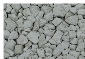
転圧後 (1 t 振動ローラー 4 回後)
