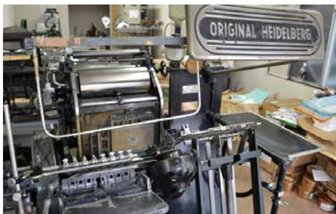
4階の工場で稼働しているハイデルベルグ社製活版印刷機
