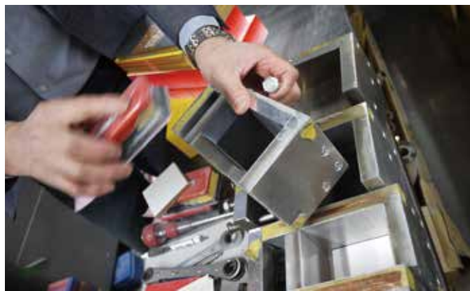
(写真上) カードの側面にヤスリをかけるための道具。平滑にしてから自作の機械で金付けする／(写真左) 四方が美しく金付けされたカード
